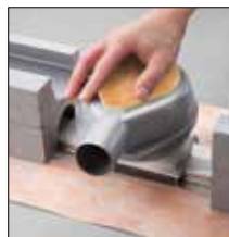
Fig. 3. Colocación del bote de salida en el adaptador
